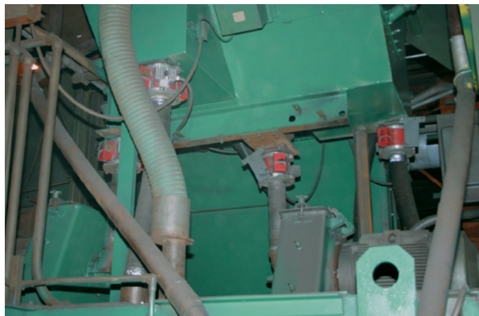
Cuatro Magna Válvulas eliminaron los paros de máquina en la operación de limpieza por chorro de Timet, proporcionaron al operador mejor control de flujo de abrasivo y optimizaron el uso de energía.
