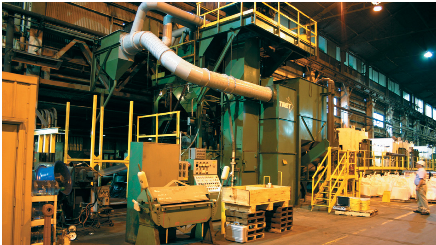
La máquina actualizada en Timet desescama bobinas de titanio.
