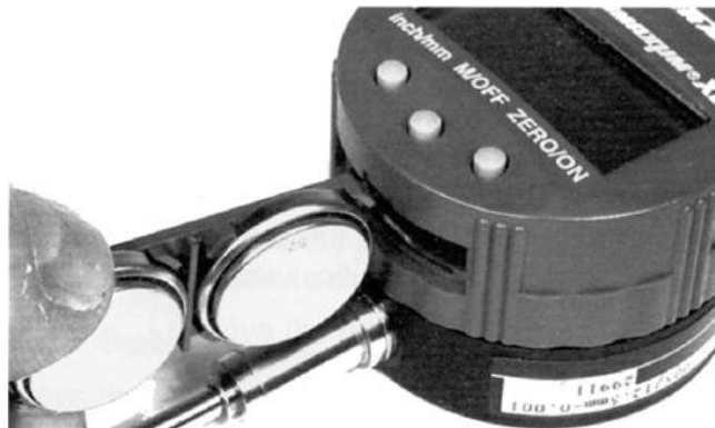
Рис. 6-2в: Замена Батарей
