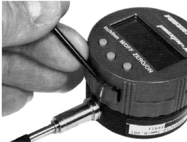
Рис. 6-2а: Замена Батарей
