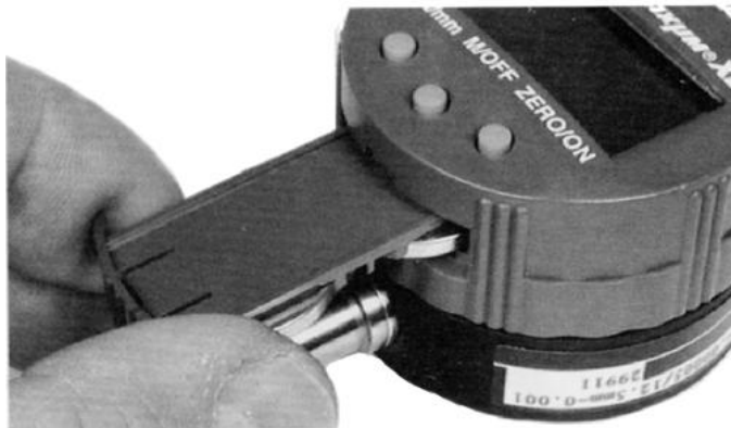
Рис. 6-2б: Замена Батарей
