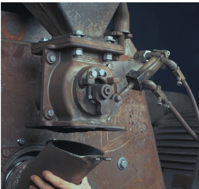
Figura 5. Removiendo el embudo de la rueda
