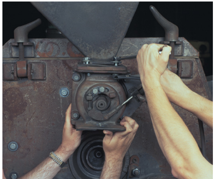
Figura 7. Afloje los tornillos encima de la válvula
