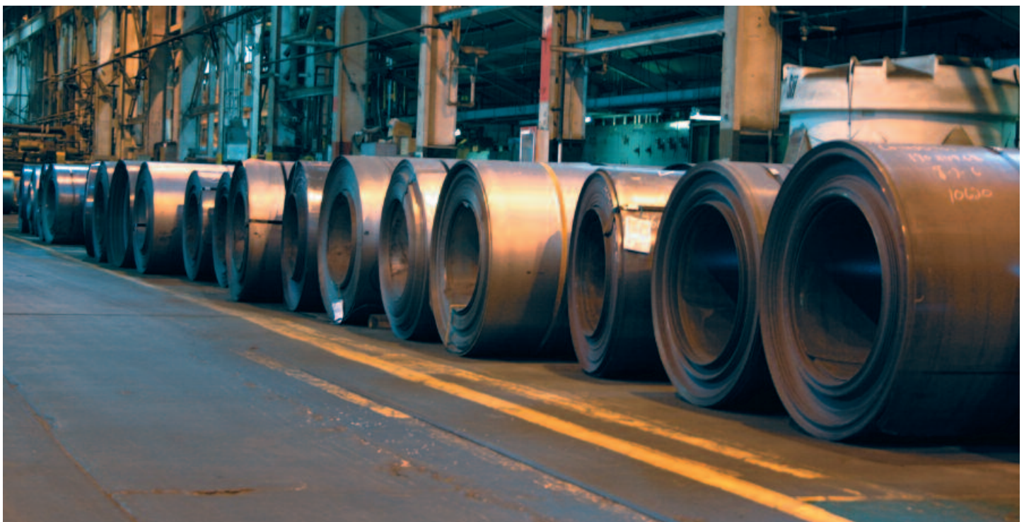
Timet es el líder reconocido en producción de cinta de titanio. La cinta de Timet es producida mediante el rolado en frío del titanio en forma de bobina y se vende ya sea en rollo o cortada a la medida y esta disponible en calidades y especificaciones grado aeroespacial e industrial.
