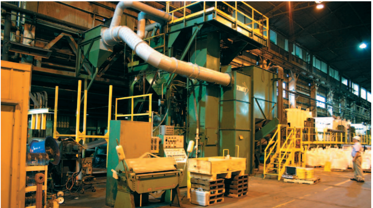
La máquina actualizada en Timet desescama bobinas de titanio.
